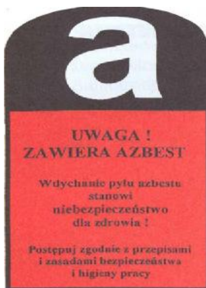
Rysunek 3. Oznakowanie wyrobów i odpadów zawierających azbest, wysokość znaku powinna wynosić co najmniej 5 cm, a szerokość co najmniej 3 cm
